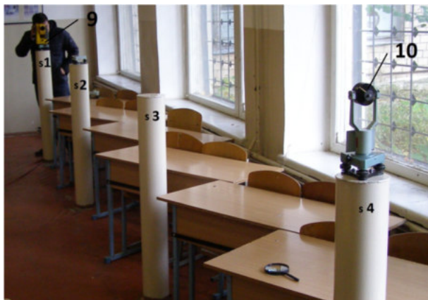
Рис. 1. Вимірювання відстаней за допомогою тахеометра Trimble 3305 DR
