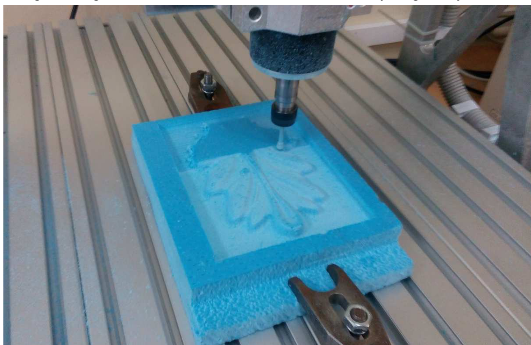
Рис. 4. Виготовлення декоративного елемента на верстаті з ЧПК
