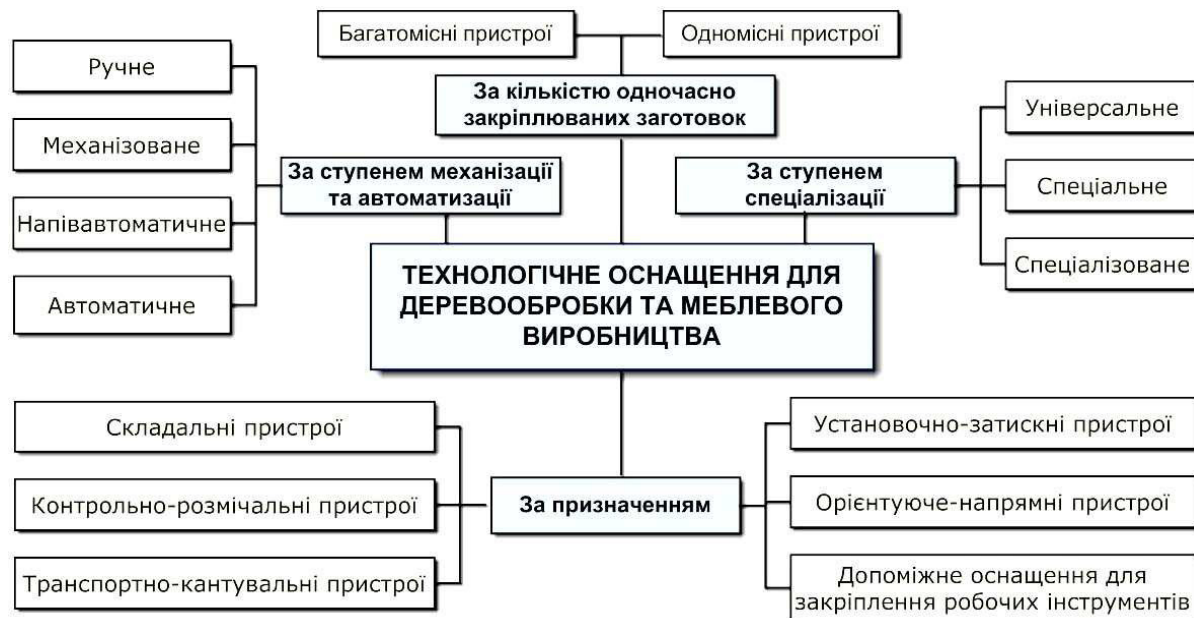
Рис. 1. Класифікація технологічного оснащення для деревообробки
