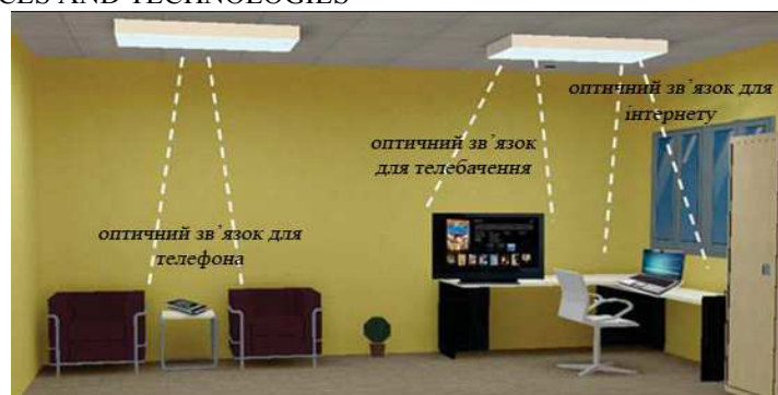
Рис. 1. Використання світлодіодного освітлення для побудови локальних мереж
