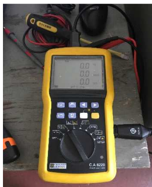
Рис. 6. Вимірювальний перетворювач активної потужності С.А 8220
