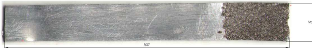
Рис. 2. Загальний вигляд зразка після електроіскрової обробки поверхні
