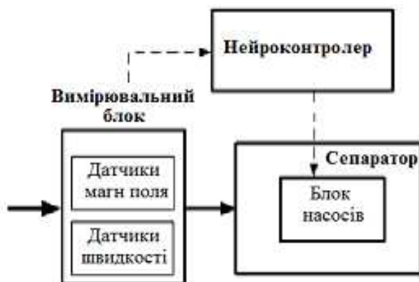
Рис. 5. Структурна схема автоматизованої системи управління сепаратора наночастинок із магнітною системою Фарадея з використанням нейроконтролера
