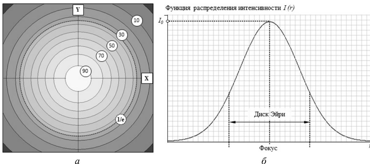
Рис. 1. Функция распределения интенсивности лазерного луча в ФП
