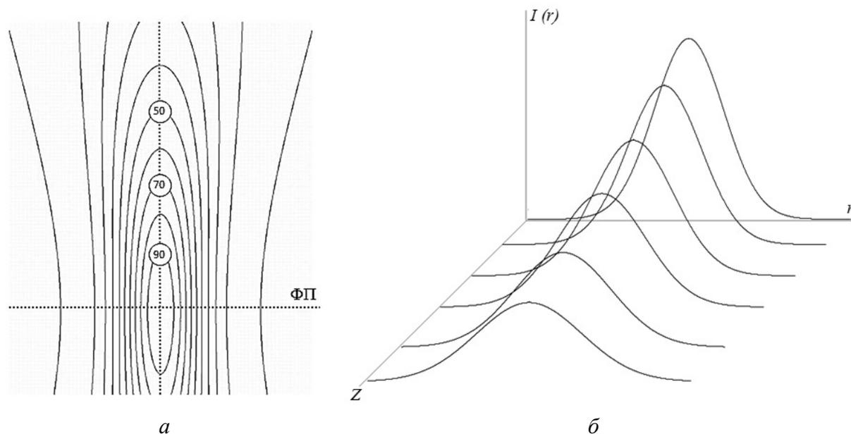
Рис. 5. Вертикальный срез функции распределения интенсивности лазерного луча
