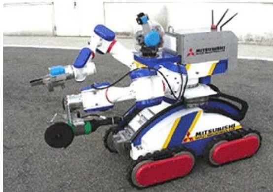
Рис. 9. Робот спеціального призначення для роботи на атомних станціях «МНІ-МЕІSTeR»
