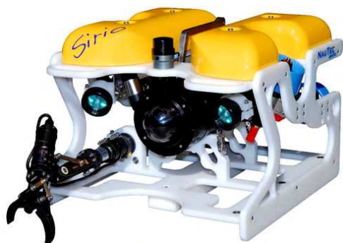
Рис. 6. Робот для підводно-технічних операцій «Ageotec Sirio»
