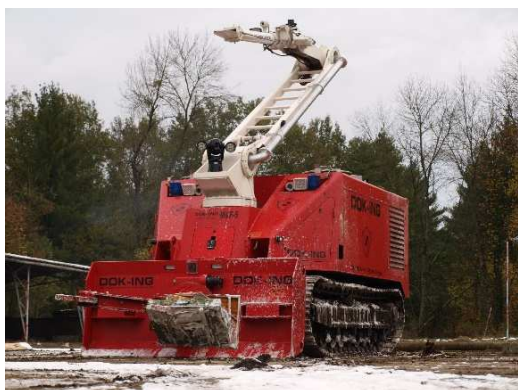
Рис. 10. Багатофункціональний пожежний робот «MVF-5»
