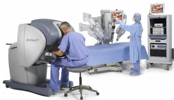
Рис. 3. Роботизована хірургічна система-маніпулятор «Da Vinci»
