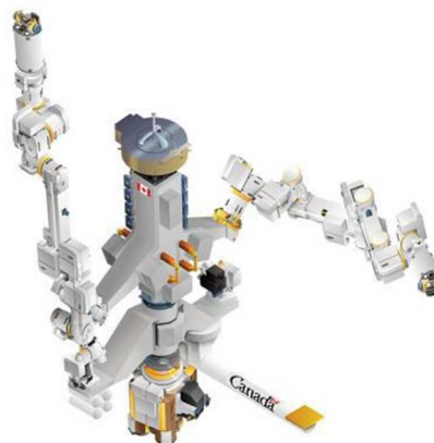
Рис. 7. Гнучкий маніпулятор спеціального призначення «Dextre»
