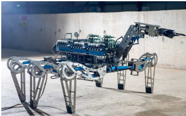
Рис. 8. Робот-наук для видалення та сортування радіоактивних матеріалів «Latro»
