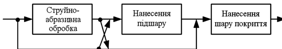
Рис. 1. Структура операцій створення поверхонь деталей із покриттями методом електродугового напилення
