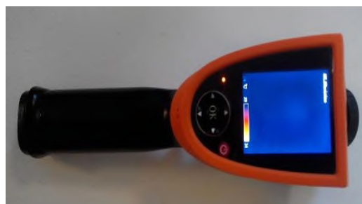
Рис. 10. Тепловізор моделі ULIRVISION TI-384
