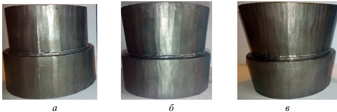
Рис. 2. Обичайки після кування ( D_y/d_{cp}=1,85 ): а – D_в/d_{cp} = 2,5 ; б – D_в/d_{cp} = 2,4 ; в – D_в/d_{cp} = 2,3
