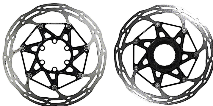
Рис. 4. Типи кріплення дискових гальм до колеса
