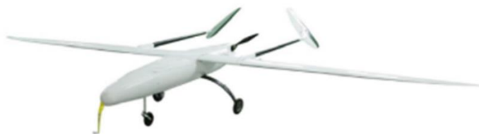
Рис. 2. Дрон літакового типу з нерухомим крилом Джерело: [10].
