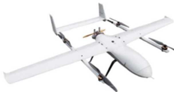
Рис. 3. Дрон гібридного типу (з гвинтами і крилами) Джерело: [10].
