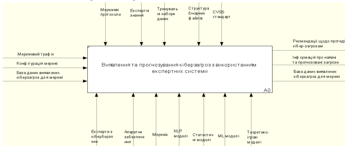
Рис. 1. Функціональна модель процесу виявлення та прогнозування кіберзагроз з використанням експертних систем
