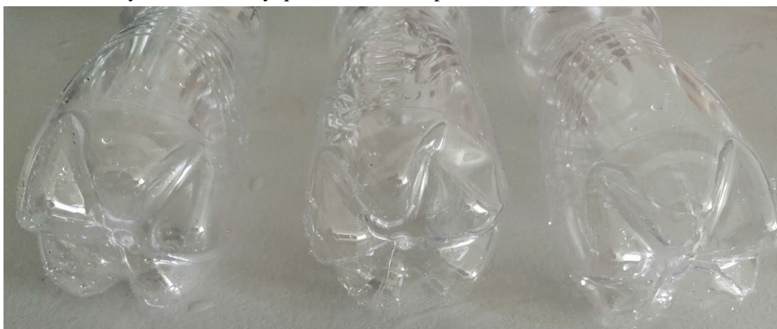
Рис. 6. Місця руйнування полімерних оболонок за умови «неоптимального» розподілення полімерного матеріалу Джерело: розроблено авторами.
