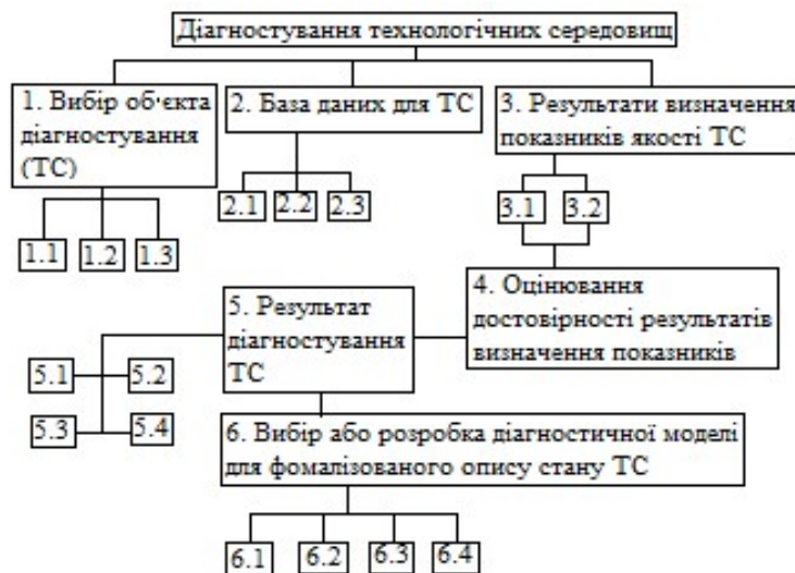
Рис. 1. Принципова схема процесу діагностування технологічних середовищ оливонаповненого обладнання АЕС: ТС – технологічні середовища оливонаповненого обладнання; ОНО – оливонаповнене обладнання; 1.1 – вибір діагностичного забезпечення; 1.2 – вибір засобів діагностування ТС; 1.3 – вибір алгоритму діагностування ТС; 2.1 – технічний стан ОНО; 2.2 – місце відбору проб ТС із ОНО; 2.3 – нормативні показники якості ТС; 3.1 – відповідність встановленим нормам для ТС; 3.2 – невідповідність встановленим нормам для ТС; 5.1 – результат визначення виду стану ТС в ОНО; 5.2 – результат визначення можливих причин зміну стану ТС в ОНО; 5.3 – результат прогнозування стану ТС в ОНО; 5.4 – висновок про результат діагностування ТС; 6.1 – аналітичний опис стану ТС; 6.2 – табличний опис стану ТС; 6.3 – графічний опис стану ТС; 6.4 – інші форми опису стану ТС Джерело: адаптовано з робіт [20; 21].
