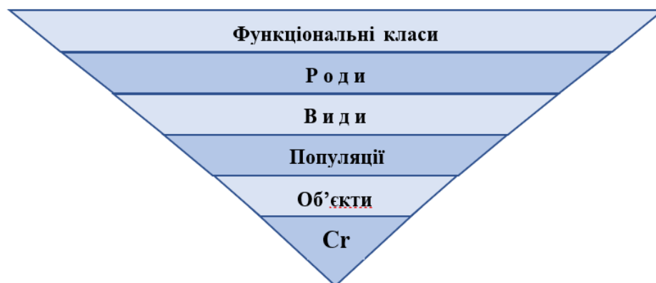
Рис. 2. Рівні структурної організації електромеханічних систем (Cr – хромосомний рівень, представлений породжувальними джерелами електромагнітного поля (електромагнітними хромосомами))
