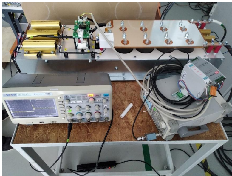
Рис. 2. Транзисторний чоппер на випробуваннях у випробувальній лабораторії ТОВ «Плутон ІС»
