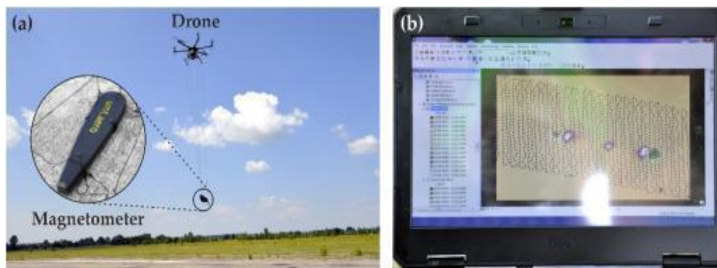
Рис. 9. БПЛА з магнітометром у процесі обстеження території (а) та візуалізації та обробки даних просторового пошуку (б)
