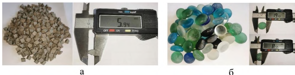
Рис. 4. Елементи робочого середовища та їх розміри: а – галтувальні тіла; б – декоративні елементи
