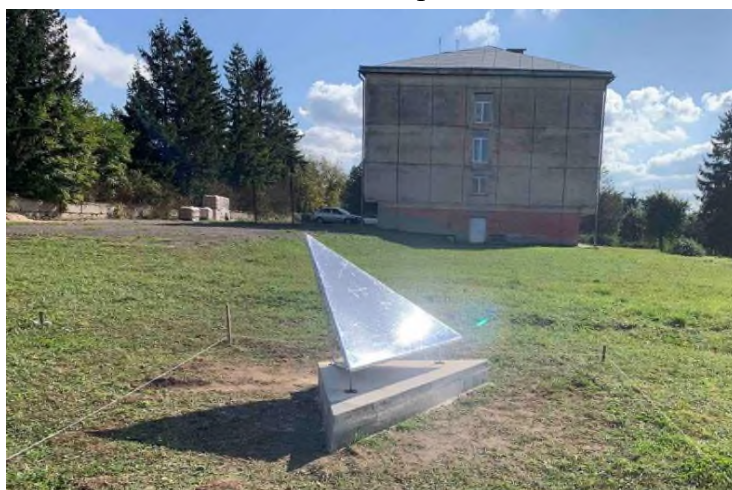
Рис. 4. Трикутний кутовий відбивач із захисним екраном, встановлений у м. Бережани Джерело: [Помилка! Джерело посилання не знайдено.].
