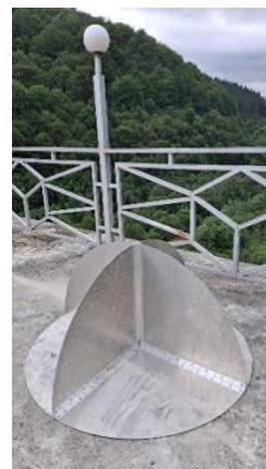
Рис. 2. Круговий чотиригранний кутковий відбивач з довжиною ребра 1,0 м, встановлений на дамбі Теремле-Ріцької ГЕС та графік інтенсивності зворотного розсіювання у місці його розгортання
