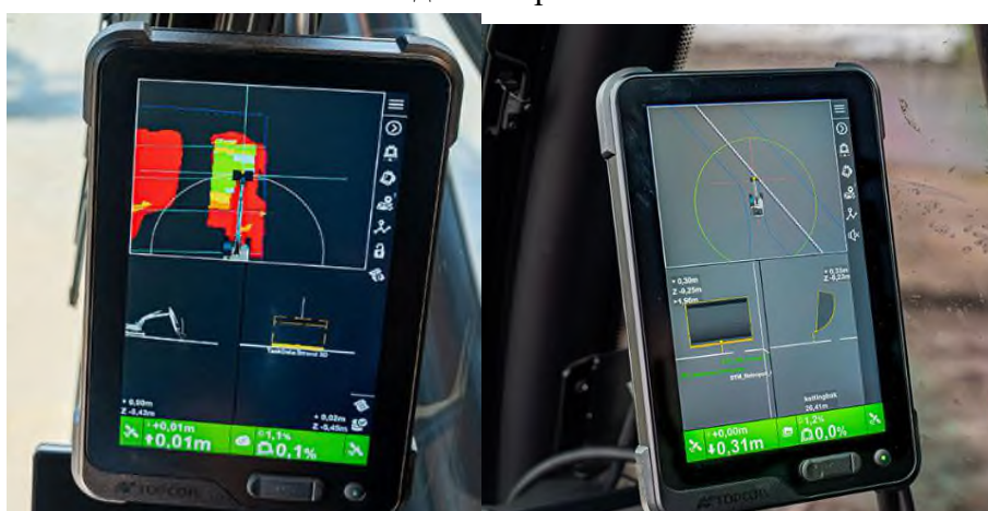
Рис. 4. Приклад відображення інформації на панелі контролера системи 3D-MC Mobile GNSS TWIN [4]
