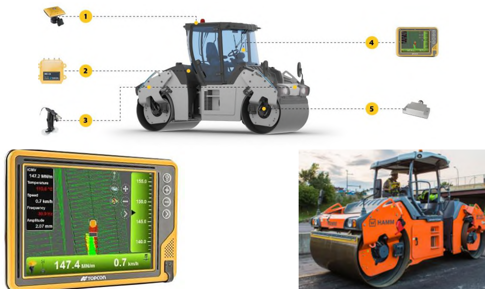
Рис. 8. Системи інженерно-геодезичного контролю та автоматизованого керування котками MC-53:
