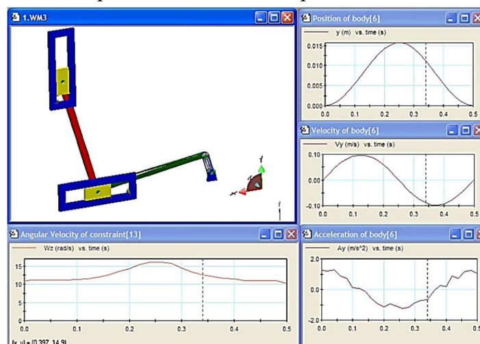
Рис. 8. Моделювання руху механізму штанцювального преса
