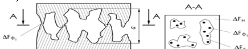
Рис. 1. Схема механічного контакту двох твердих тіл:
