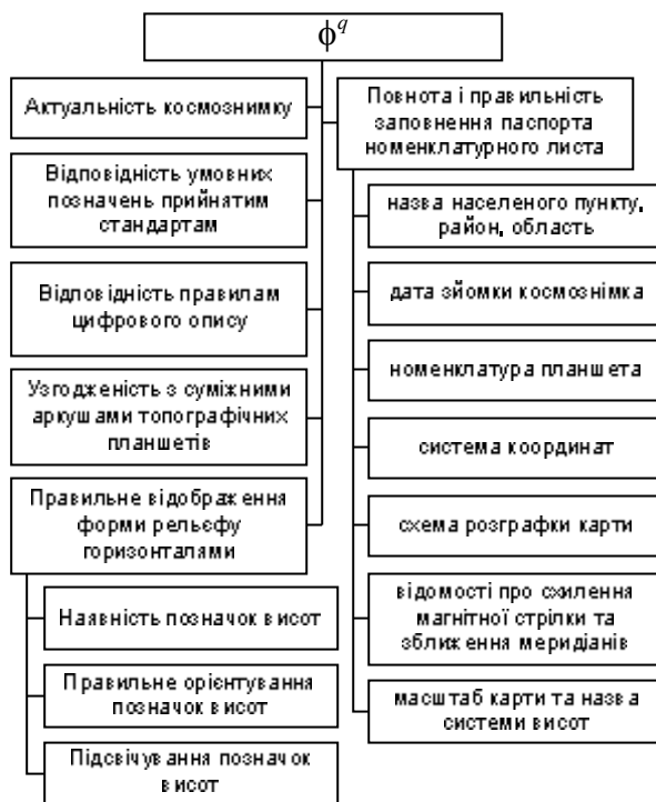
Рис. 3. Дерево показників якісного оцінювання топографічного планшета
