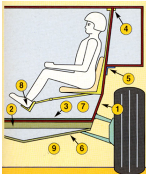
Рис. 5. Схематичне зображення критеріїв протимінного захисту високого рівня
