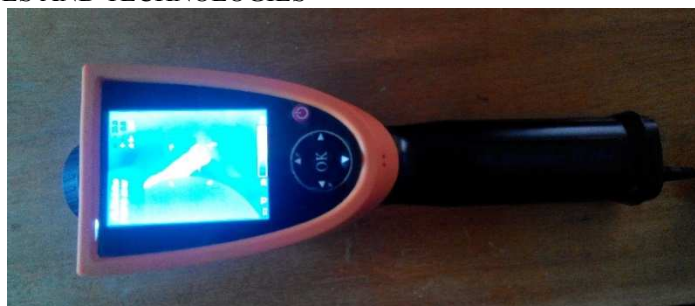
Рис. 10. Тепловізор моделі URIRVISION TI-384
