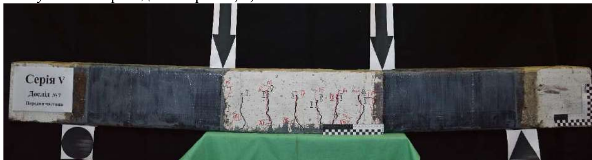
Рис. 1. Схема усиления нижней растянутой зоны и приопорных участков поврежденных железобетонных балок серии 3 с большим пролетом среза
