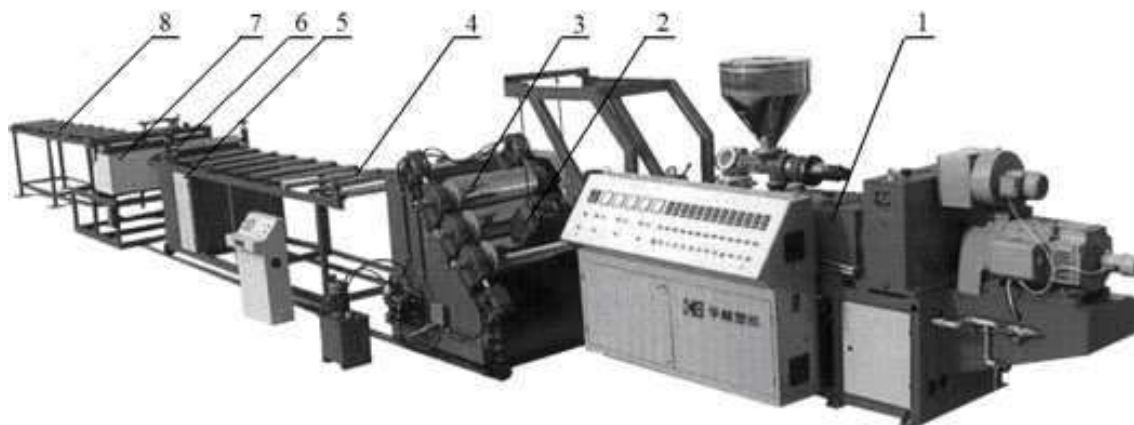
Рис. 1. Загальний вигляд лінії для виробництва одношарових листів: 1 – екструдер, 2 – екструзійна головка, 3 – калібрувальний каландр, 4 – рольганг для охолодження листів, 5 – пристрій для поздовжнього різання бічних крайок, 6 – тягучий пристрій, 7 – пристрій для поперечного різання листів, 8 – штабелеукладач
