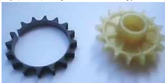
Рис. 10. Вирізування формуючої зубців зірочки матриці дротяним електродом і відповідний виливок натяжної (відхиляючої) зірочки
