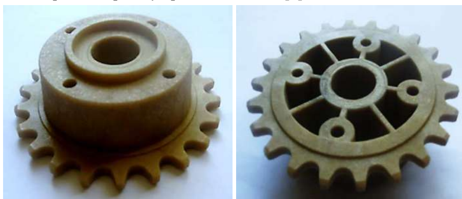
Рис. 9. Зірочка, інтегрована з барабаном і кришкою кріплення
