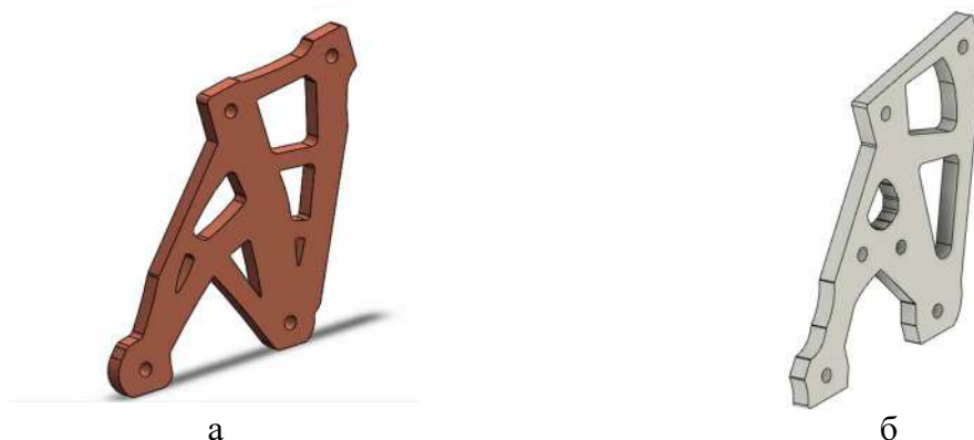
Рис. 14. Оптимізовані кронштейни: а – в SolidWorks; б – в Fusion 360
