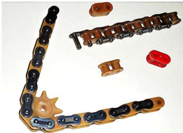
Рис. 15. Інтегровані монолітні внутрішні ланки металополімерного ланцюга
