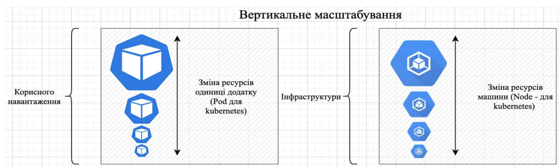
Рис. 3. Схема вертикального масштабування у Kubernetes
