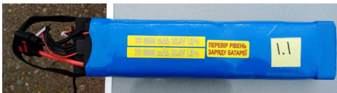
Рис. 5. Акумуляторна батарея системи вертикального зльоту та посадки Технічні характеристики джерела живлення СВЗП наведено в табл. 9.
