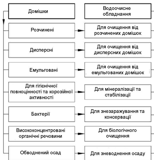
Рис. 6. Класифікація водоочисного обладнання
