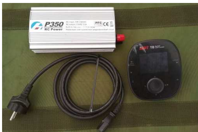
Рис. 2. Комплект для заряду АКБ: блок живлення, зарядний пристрій, кабель живлення від мережі 220В
