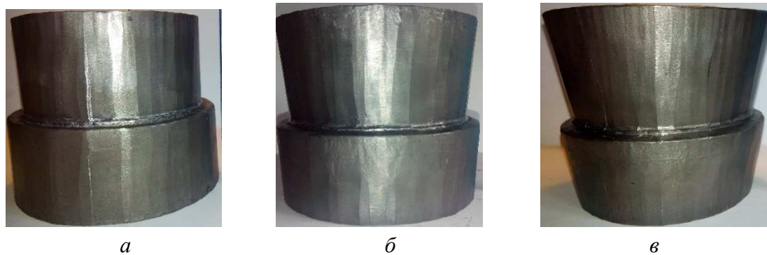
Рис. 2. Обичайки після кування ( D_y/d_{cp}=1,85 ):
