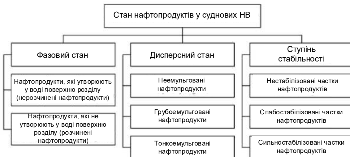
Рис. 5. Характеристика стану нафтопродуктів у суднових нафтовмісних водах
