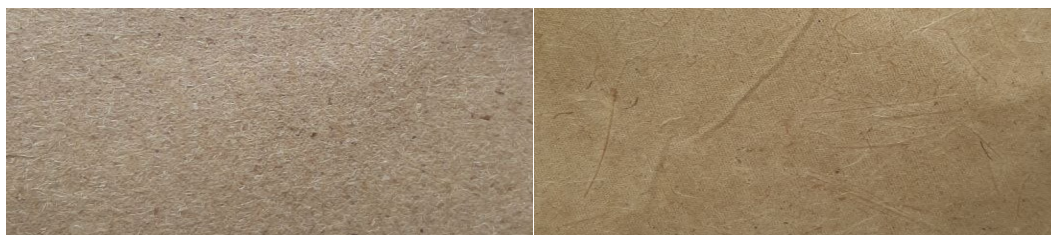
Рис. 3. Зовнішній вигляд зразків волокнистих напівфабрикатів із обгортки качанів кукурудзи
