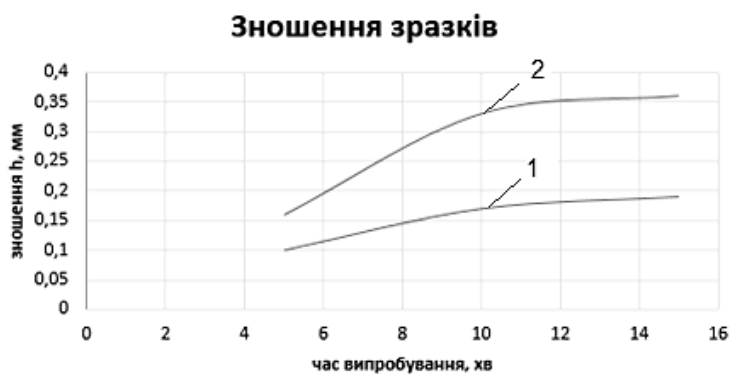
Рис. 3. Зношення поверхні дослідних зразків: 1 – після зміцнення, 2 – без зміцнення
