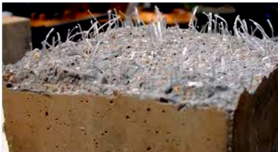
Рис. 1. Внутрішня структура фібробетону
