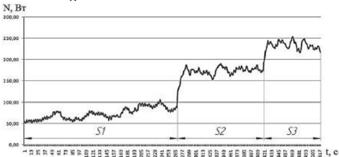
Рис. 7. Графік активної потужності під час процесу шліфування з паралельними осями круга та деталі
