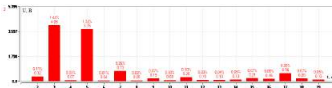
Рис. 20. Гістограма гармонік напруги (конденсаторна батарея з фільтром)
