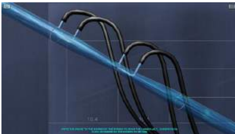
Рис. 6. Схема відводу рідини з різних частин перерізі головної труби
