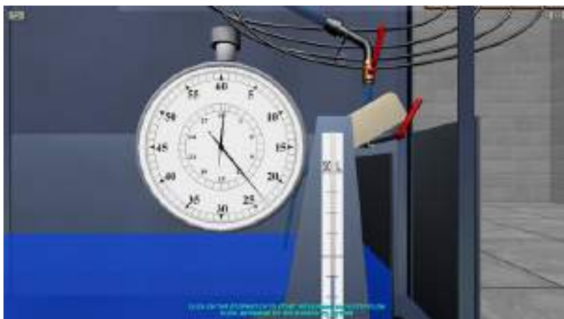
Рис. 9. Схема системи для вимірювання об'єму рідини за заданий час
