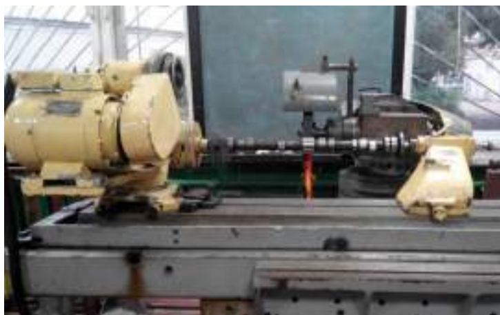
Рис. 4. Процес шліфування опорних шийок розподільчого вала
