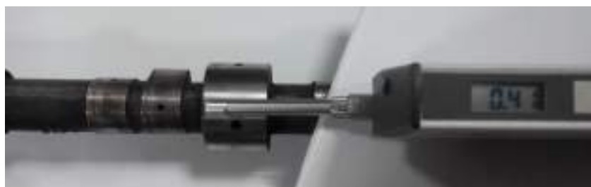
Рис. 16. Результат вимірювання шорсткості поверхні опорної шийки розподільчого вала
