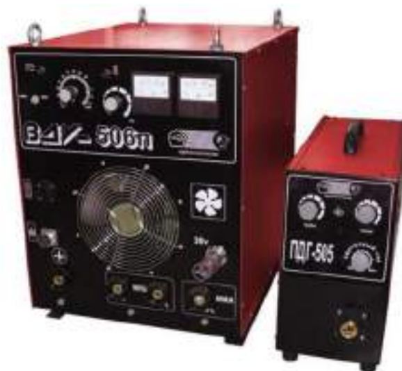
Рис. 5. Установка для зварювання в середовищах інертних та активних газів
