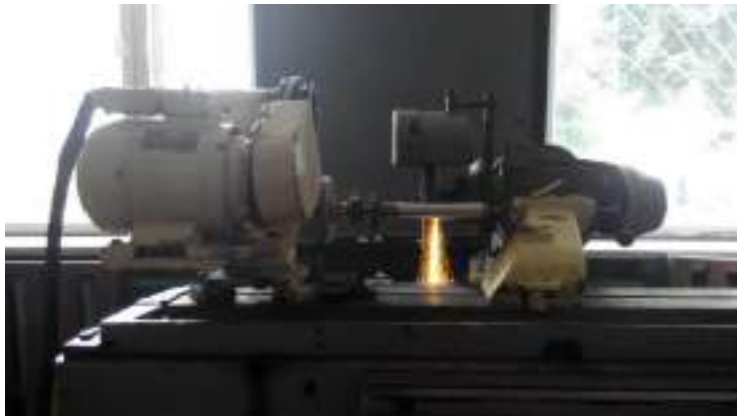
Рис. 3. Процес шліфування циліндричної поверхні вала
