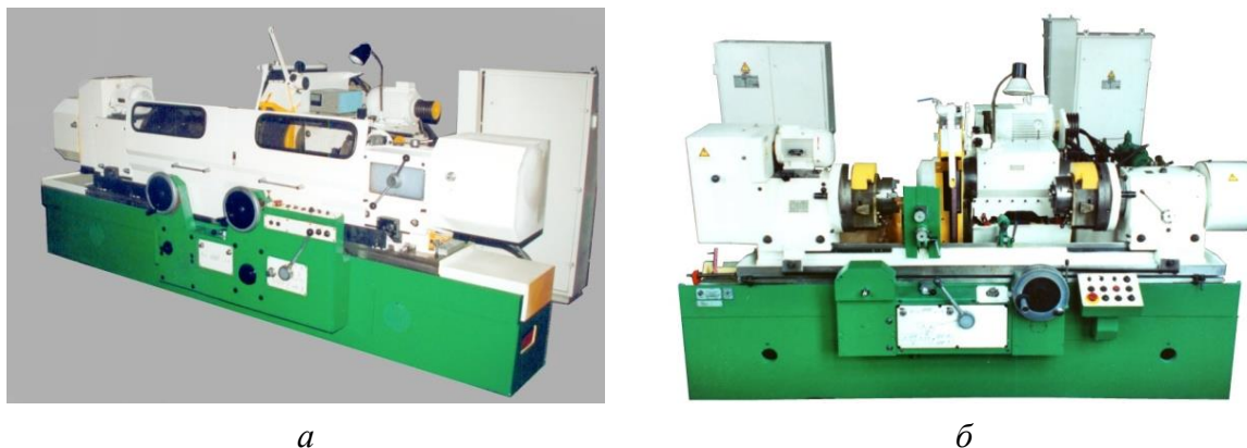
Рис. 10. Верстат для перешліфовки колінчастих валів моделі 3Д4231 (а) та 3411 (б) [10]
