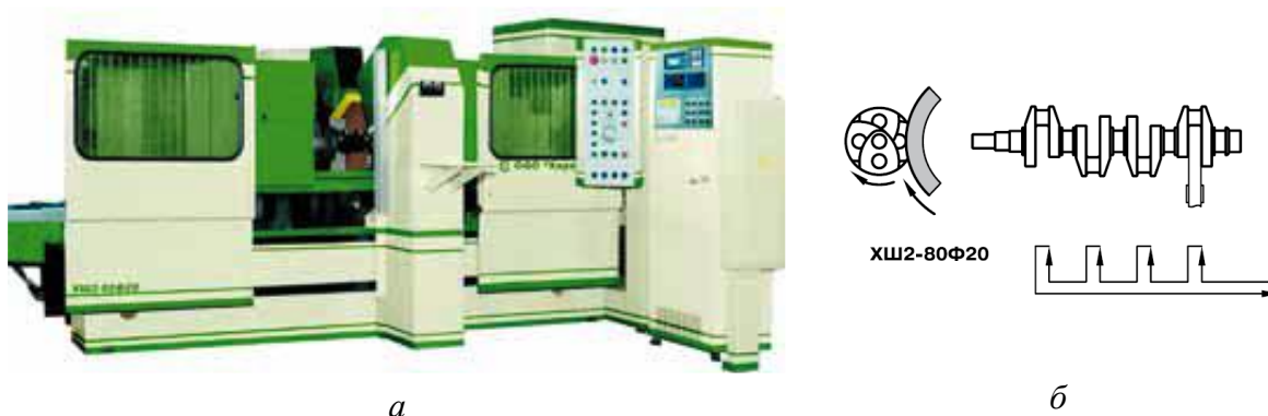
Рис. 9. Спеціальний верстат (а) для шліфування шатунних шийок колінчастого вала та схема їх обробки (б) [9]
