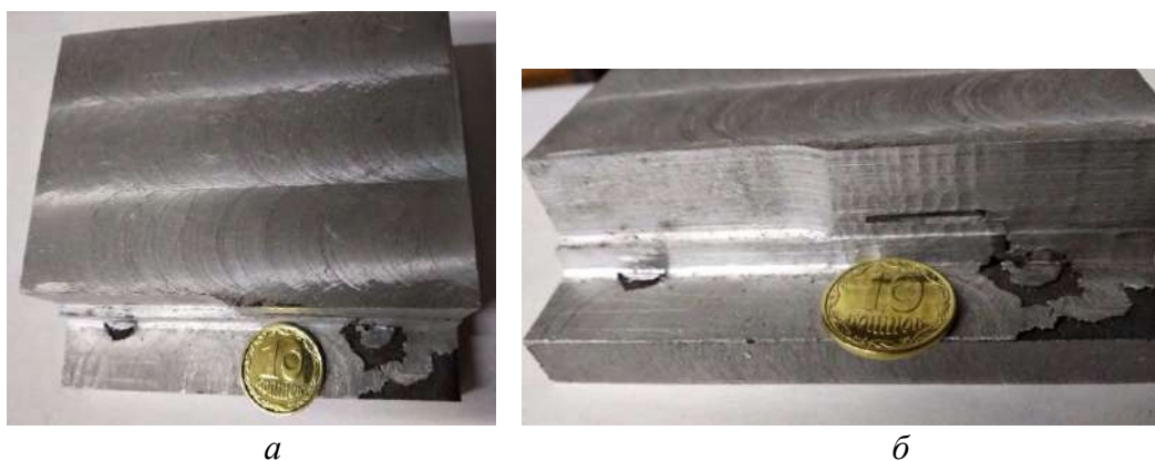
Рис. 10. Розріз біметалу в місцях встановлення утримувачів, сфотографований під різним кутом спостереження [3; 5; 11]
