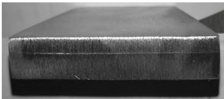
Рис. 9. Розріз біметалу, виконаного при заливці робочого шару та використанні утримуючих елементів [5; 11]
