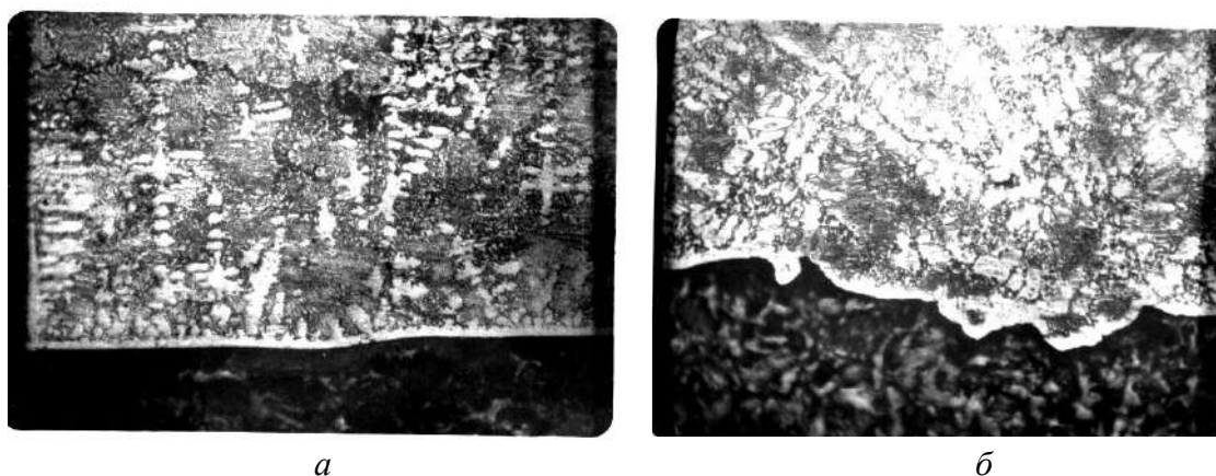
Рис. 5. Структура напиленого покриття:
