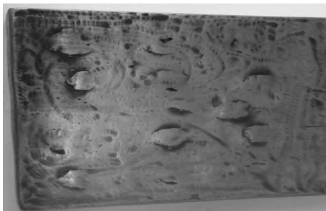
Рис. 12. Верхня поверхня пластини основи біметалу після заплвлених технологічних отворів електродуговою зваркою та подальшої зачистки [3; 5; 11]
