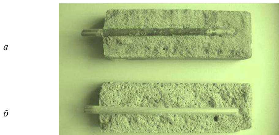
Рис. 2. Дослідження протикорозійних властивостей інгібуючої суміші на основі МЕА: а – без просочення; б – з просоченням МІК
