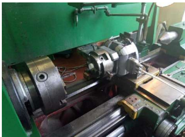
Рис. 1. Свердління отвору в заготовці зі склопластику СТЕФ-У
