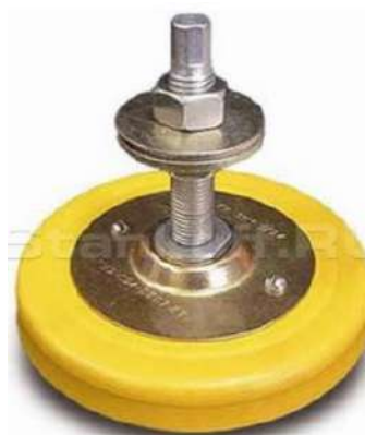
Рис. 2. Віброізолююча опора ОВ-31. Складові (знизу вгору) [6]: 1 – гумометалевий елемент; 2 – підкладка; 3 – кришка; 4 – гайка М16; 5 – шайба (2 шт.); 6 – гвинт М16; 7 – гайка регулююча М16
