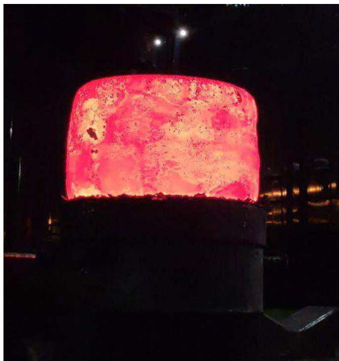
Рис. 4. Формування конусних уступів на злитку (а) та наступне осадження отриманої заготовки плоскими плитами (б)
