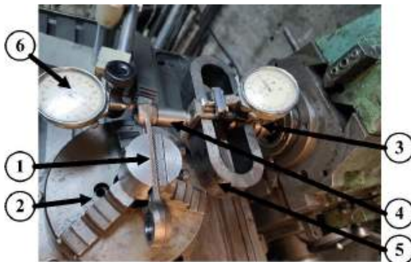
Рис. 8. Експериментальна установка для визначення переміщень елементів ВП
