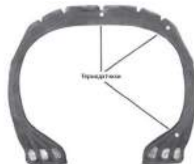
Рис. 5. Шина зі встановленими термодатчиками [12]
