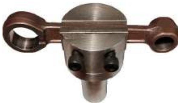
Рис. 7. Експериментальний зразок удосконаленого ВП з неповним базуванням для оброблення деталей типу шатуни
