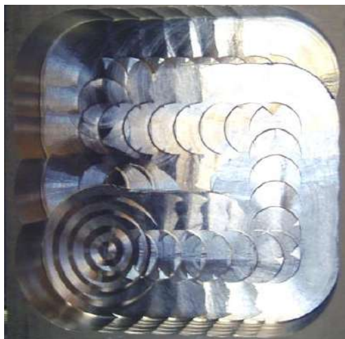
Рис. 5. Виникнення хвилястих кромки при плунжерному фрезеруванні [5]
