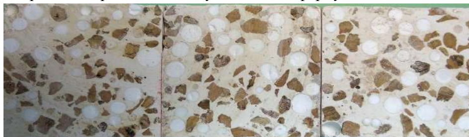
Рис. 1. Приклад структури багатокомпонентного матеріалу з крупним наповнювачем
