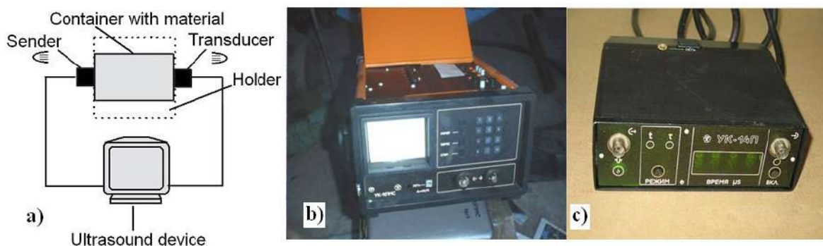
Рис. 5. Ультразвукова установка (а) та ультразвукові прилади КК-10ПМС та УК-14П (відповідно b, c)
