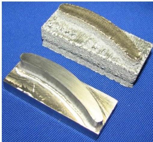
Рис. 4. Лопатка газотурбінного двигуна створена 3D-друком
