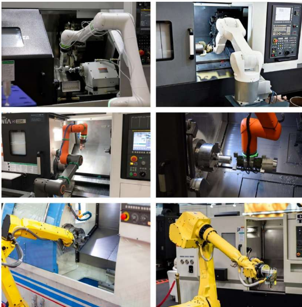
Рис. 2. Обслуговування промисловими роботами металорізальних верстатів та оброблювальних центрів з ЧПК [2–5]
