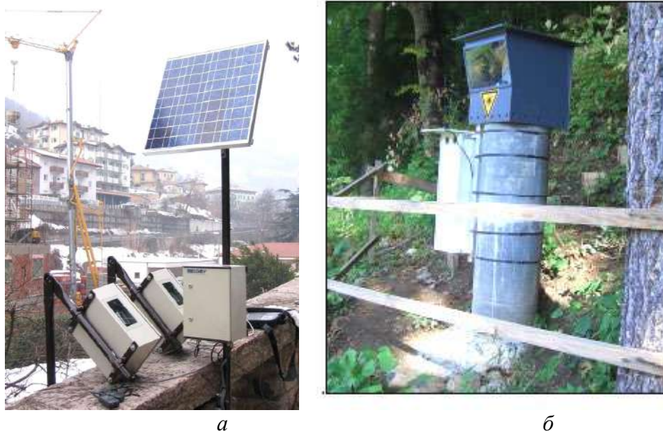
Рис. 2. 3DeMoN-Laser: а) - установка з двома лазерними приладами та станцією моніторингу з сонячним живленням; б) – установка в захисній кабіні [8]
