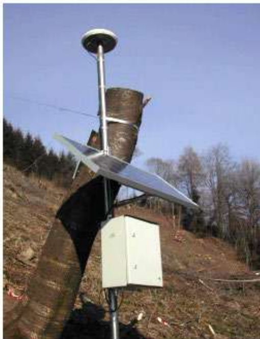
Рис. 1. Вимірювальна станція 3DeMoN на об'єкті моніторингу: GPS-ровер з сонячною батареєю [8]
