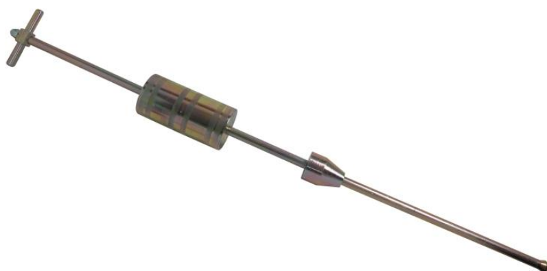
Рис. 4. Динамічний щільномір для ґрунту Д-51А
