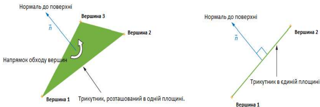
Рис. 2. Схематизація трикутника у форматі STL з вказаними вершинами та відповідною нормаллю
