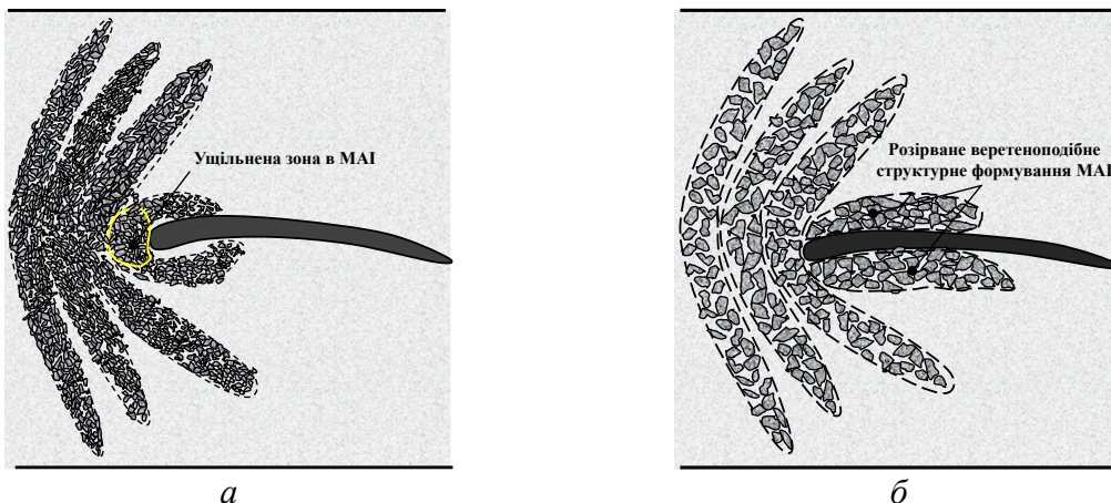
Рис. 2. Схематичне представлення взаємодії веретеноподібних формувань у МАІ сформованого з дрібнозернистих (а) та крупнозернистих (б) порошків при МАО тонкої деталі типу лопатка компресора ГТД
