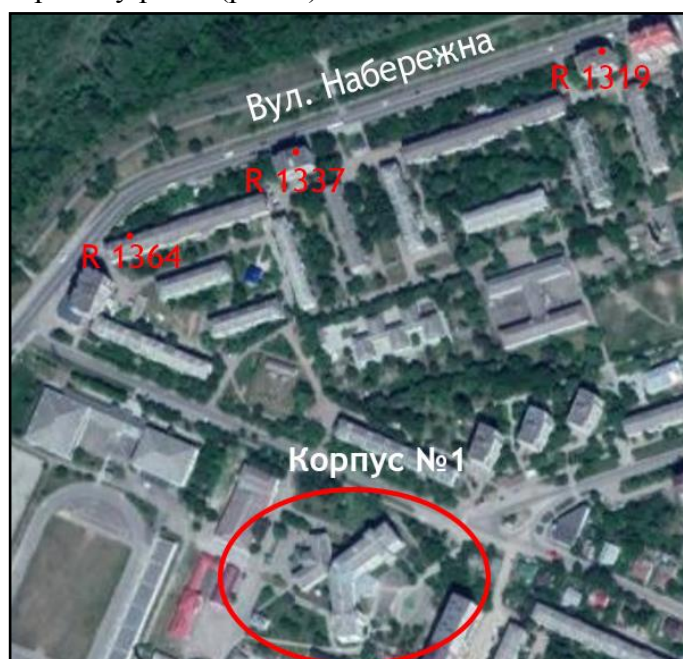
Рис. 3. Схема розміщення нівелірних знаків у районі робіт
