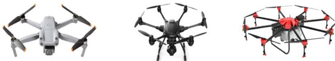
Рис. 1. Дрони роторного типу, зліва на право квадрокоптер із 4 гвинтами, гексакоптер із 6 гвинтами, октокоптер із 8 гвинтами. Джерело: [10].
