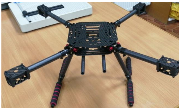
Рис. 3. Готова платформа для квадрокоптера
