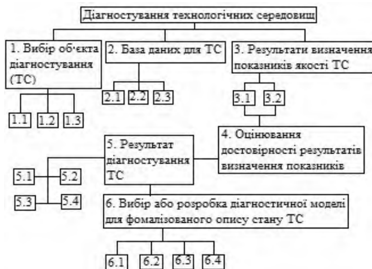
Рис. 1. Принципова схема процесу діагностування технологічних середовищ оливонаповненого обладнання АЕС: ТС – технологічні середовища оливонаповненого обладнання; ОНО – оливонаповнене обладнання; 1.1 – вибір діагностичного забезпечення; 1.2 – вибір засобів діагностування ТС; 1.3 – вибір алгоритму діагностування ТС; 2.1 – технічний стан ОНО; 2.2 – місце відбору проб ТС із ОНО; 2.3 – нормативні показники якості ТС; 3.1 – відповідність встановленим нормам для ТС; 3.2 – невідповідність встановленим нормам для ТС; 5.1 – результат визначення виду стану ТС в ОНО; 5.2 – результат визначення можливих причин зміну стану ТС в ОНО; 5.3 – результат прогнозування стану ТС в ОНО; 5.4 – висновок про результат діагностування ТС; 6.1 – аналітичний опис стану ТС; 6.2 – табличний опис стану ТС; 6.3 – графічний опис стану ТС; 6.4 – інші форми опису стану ТС Джерело: адаптовано з робіт [20; 21].
