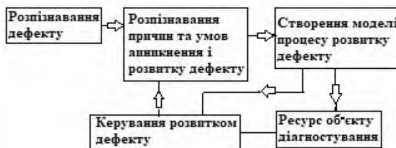
Рис. 2. Структура взаємозв'язку між завданнями діагностування [17]
