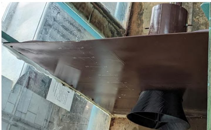
Рис. 3. Зовнішній вигляд експериментального пристрою з контрольними позначками рівня води у верхньому б'єфі
