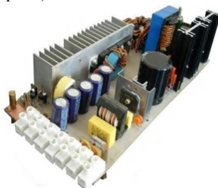
Рис. 5. Зовнішній вигляд досліджуваного джерела живлення на вихідні параметри 5 В, 50 А
