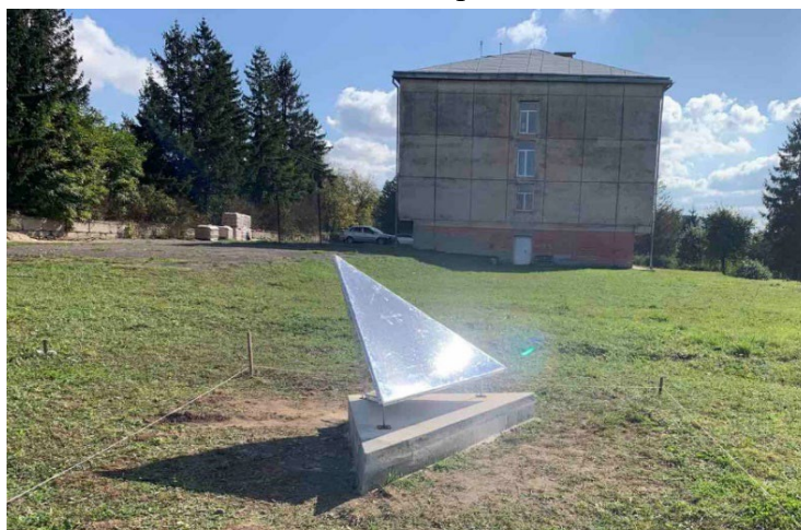
Рис. 4. Трикутний кутовий відбивач із захисним екраном, встановлений у м. Бережани Джерело: [9].
