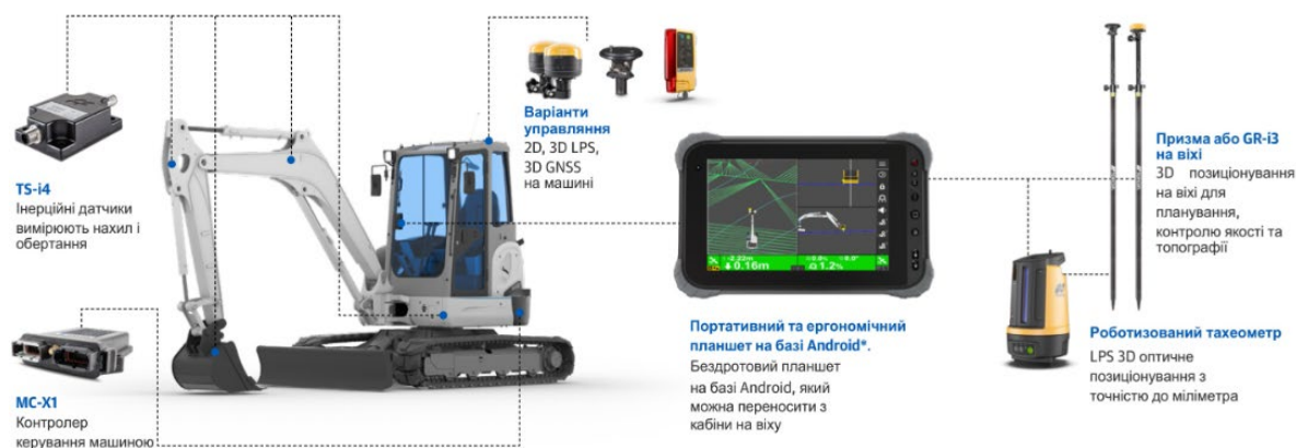
Рис. 2. Системи інженерно-геодезичного контролю та автоматизованого керування землерийними машинами 3D-MC Mobile GNSS TWIN [4]
