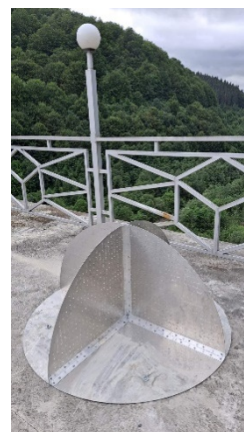
Рис. 2. Круговий чотиригранний кутовий відбивач з довжиною ребра 1,0 м, встановлений на дамбі Теремле-Ріцької ГЕС та графік інтенсивності зворотного розсіювання у місці його розгортання
