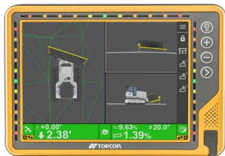
Рис. 5. Приклад відображення інформації на панелі контролера системи 3D-MC Max GNSS TWIN [4]
