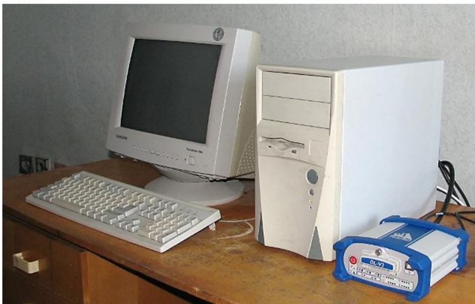
Рис. 2. Оновлене обладнання на станції «Чернігів» – приймач NovAtel DL-V3
