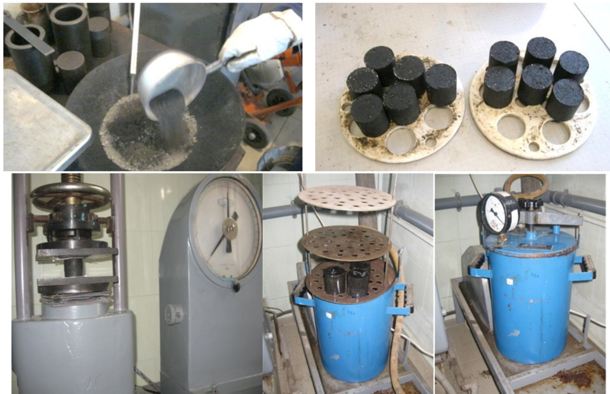
Рис. 4. Процес виготовлення експериментальних зразків 5 та 10 % виявлення фізико-механічних властивостей зразків ОМС з різним вмістом заміника мінерального порошку
