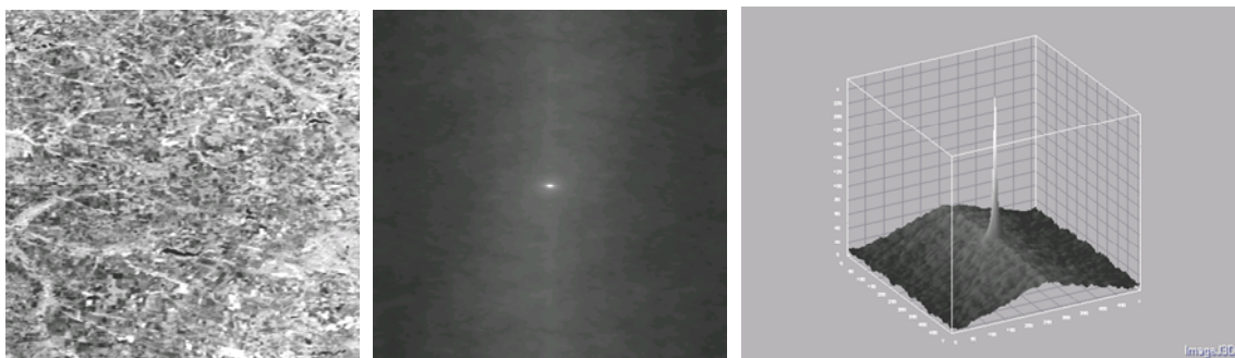
Рис. 2. Знімок радіометра Modis KA Terra, його автокореляційна функція
